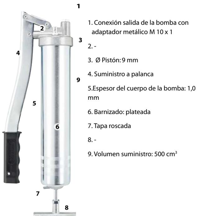
1. Conexión salida de la bomba con adaptador metálico M 10 x 1
